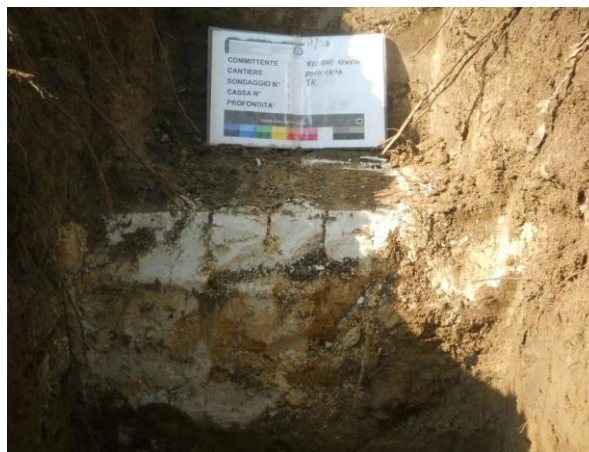
Figura 17 – Foto del diaframma in corrispondenza della trincea n.13. Diaframma compatto, si possono vedere i segni della benna dell’escavatore
